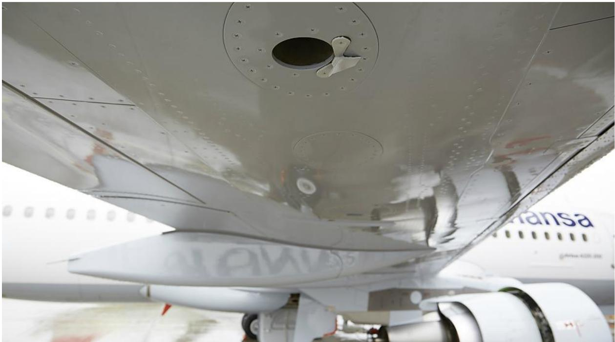
*Der Wirbelgenerator unterdrückt, an die Tankdruckausgleichsöffnung montiert, die Entstehung lauter Pfeifgeräusche. (Quelle: Lufthansa)*
