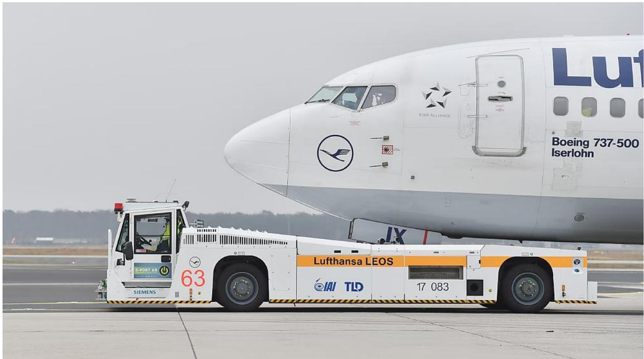
*TaxiBots schleppen Flugzeuge über das Flughafengelände. Die Triebwerke der Flugzeuge bleiben dabei aus – das reduziert die Lärmbelastung während des Rollvorgangs. (Quelle: Jürgen Mai/Lufthansa Technik)*
